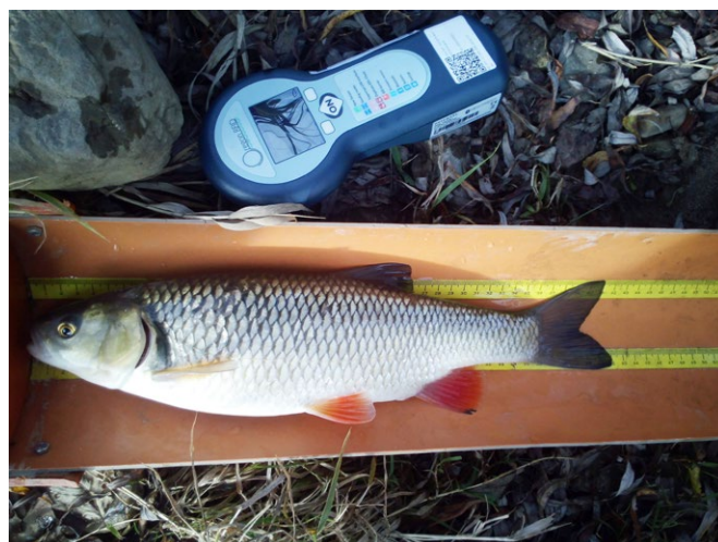
Ręczny czytnik sygnału i unikalnego kodu z wszczepionego rybom implantu
