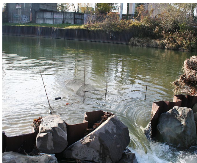
Pułapka z siatki do monitorowania wędrówki ryb w górę rzeki
