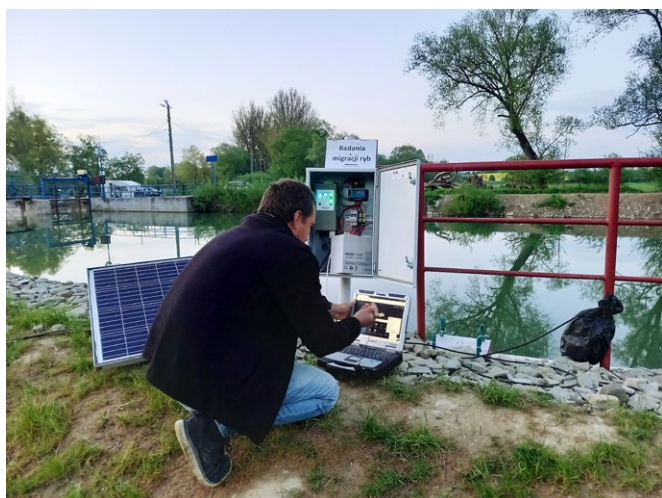
Rejestrator migracji z wykorzystaniem nadajników pasywnych w Szczepańcowej
