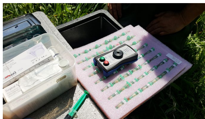
Zestaw nadajników akustycznych do znakowania ryb
