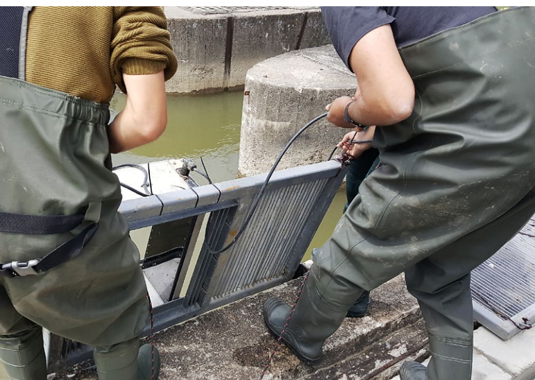
Montowanie skanera na przepławce technicznej w Dębicy
