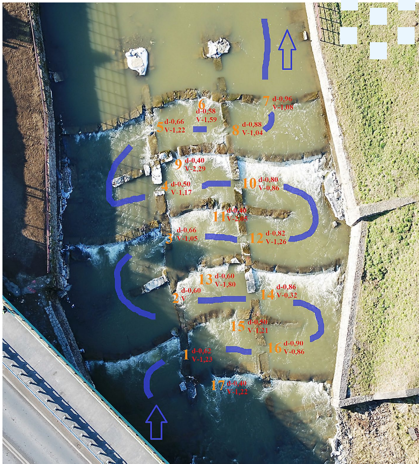
Wyniki pomiarów prędkości wody w szczelinach i zaprojektowana droga migracji ryb w przepławce w Gorlicach (centrum)
